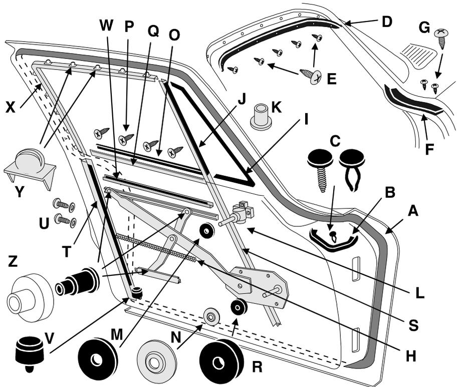
**K 63-67 Coupe Vent Hinge Pivot Rivets**
